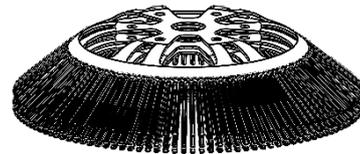
3- Positionner le bol glisseur et l'écrou fourni avec votre débroussailluse
